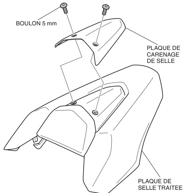
7. Montez le carénage de selle dans l'ordre inverse de la dépose.
